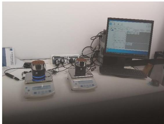
Fig. 4. HYPROP-2 test
